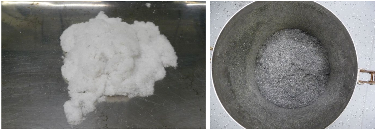
Abbildung 3: Weißes Vlies (links) und Teppichreste (rechts), zerkleinert auf eine Korngröße von < 2 mm
