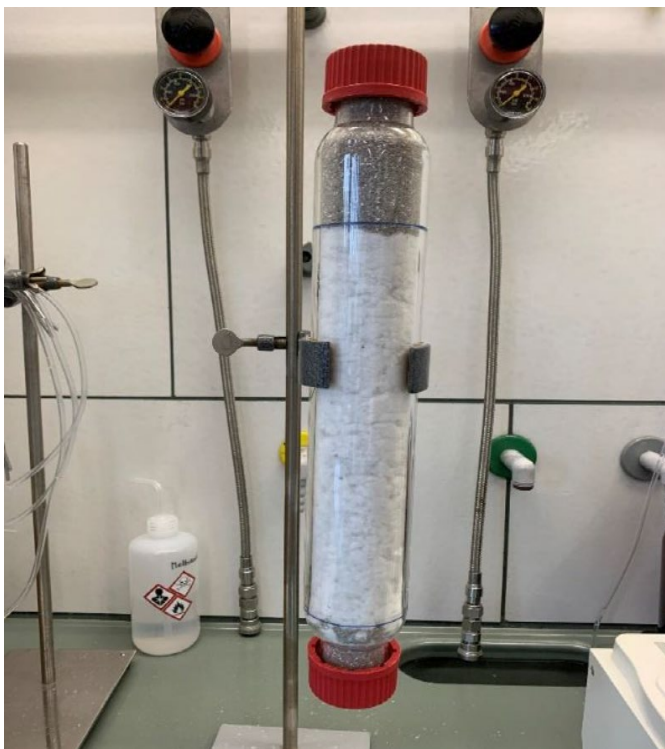
Abbildung 4: Säulenansatz mit einer Menge von 50 g an zerkleinertem, weißem Vlies
